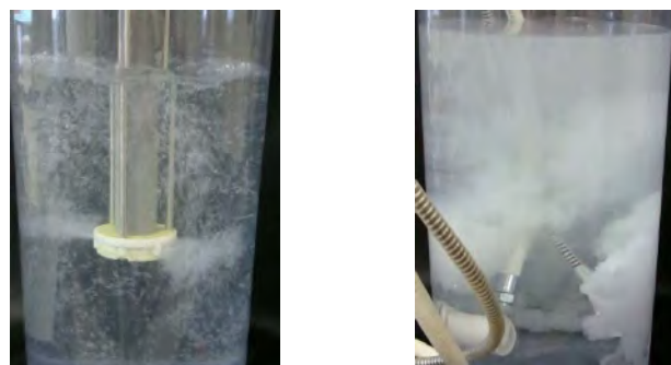
マイクロナノバブル発生装置 (左)気液二相流旋回方式、(右)加圧溶解方式
