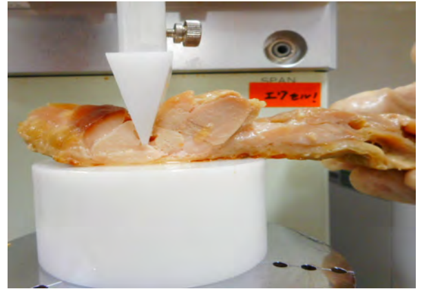
クリープメーターによる破断応力の測定
