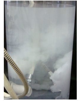
マイクロナノバブル発生装置 (左)気液二相流旋回方式、(右)加圧溶解方式)
