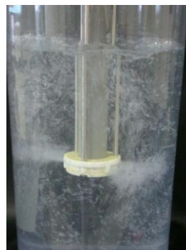
マイクロナノバブル発生装置 (左)気液二相流旋回方式、(右)加圧溶解方式)
