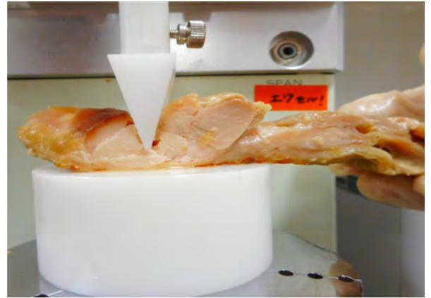
クリープメーターによる破断応力の測定
